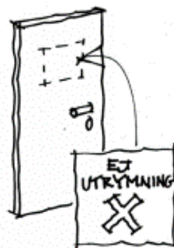
Figur 3. Text på utrymningsdörrar i utrymningskorridor.
